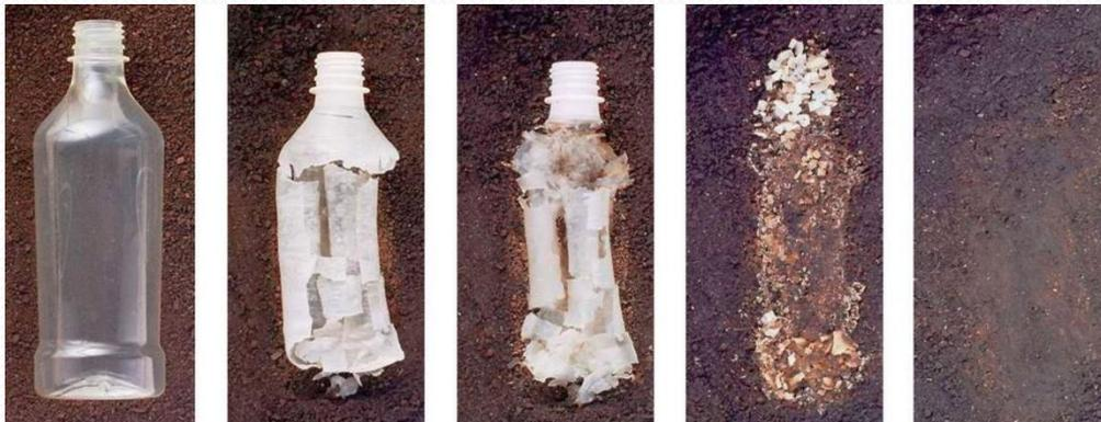
Degradazione delle bioplastiche nel terreno
