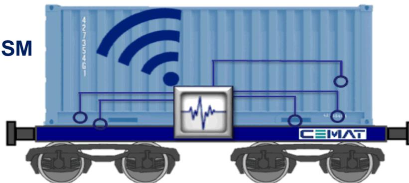
I dati vengono trasmessi dai sensori alla centralina via cavo. Dalla centralina i dati vengono trasmessi via rete cellulare ad un Cloud e successivamente integrati nei sistemi aziendali di Cemat. La **frequenza** della trasmissione dati è stata fissata in:
