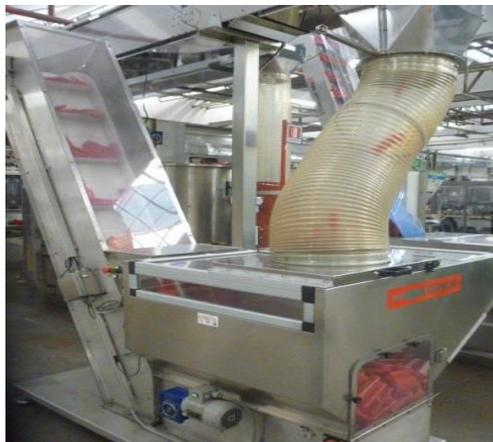
Un fornitore è installato presso locali in stabilimento per produzione flaconi, anche in alimentazione diretta
