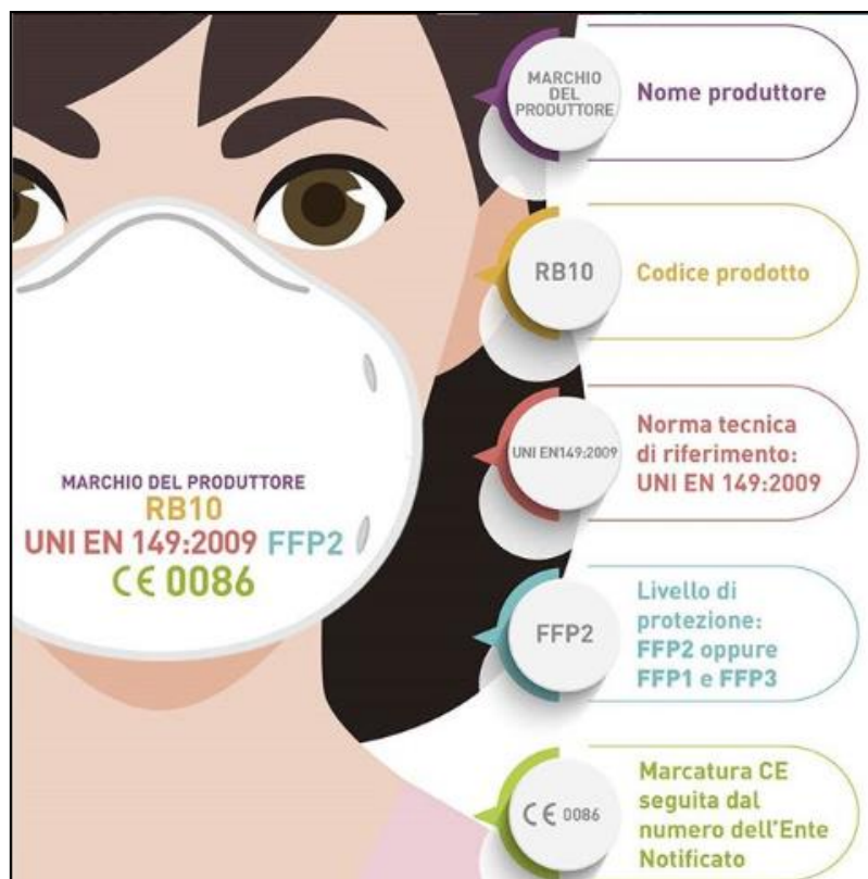
Figura 1 Esempio di marcatura su un facciale filtrante antipolvere
