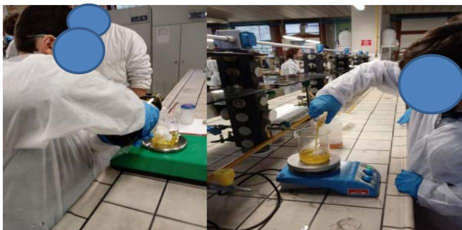
Successivamente ho messo 17,85 gr di NaOH (soda caustica) all'interno di una beuta ed ho aggiunto essenza di lavanda: si è generata una reazione chimica esotermica che ha raggiunto la temperatura di 90°, prontamente raffreddata con ghiaccio ed acqua , prestando attenzione che le scaglie di soda caustica fossero tutte sciolte.
